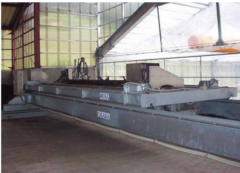
搬送コンベアを不要にした、原料散布ホッパー
