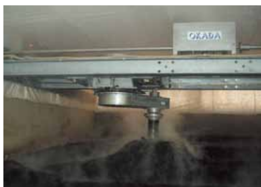
堆肥化発酵槽内を攪拌中のスクリー
