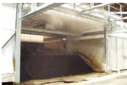
自在スクリー方式により各槽を自動攪拌
